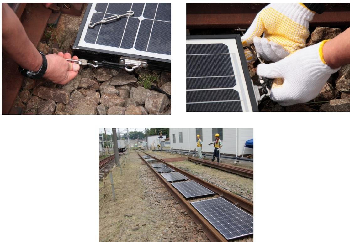
図 4.7 鉄道総研での脱着試験
