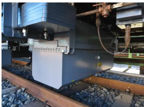
図 11.1 軌道変位常時監視システム（試作品）
